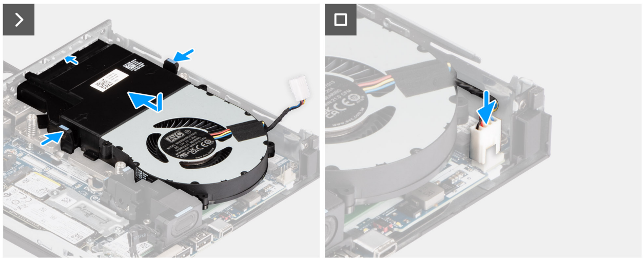
Abbildung 31. Einbauen des Lüfters
