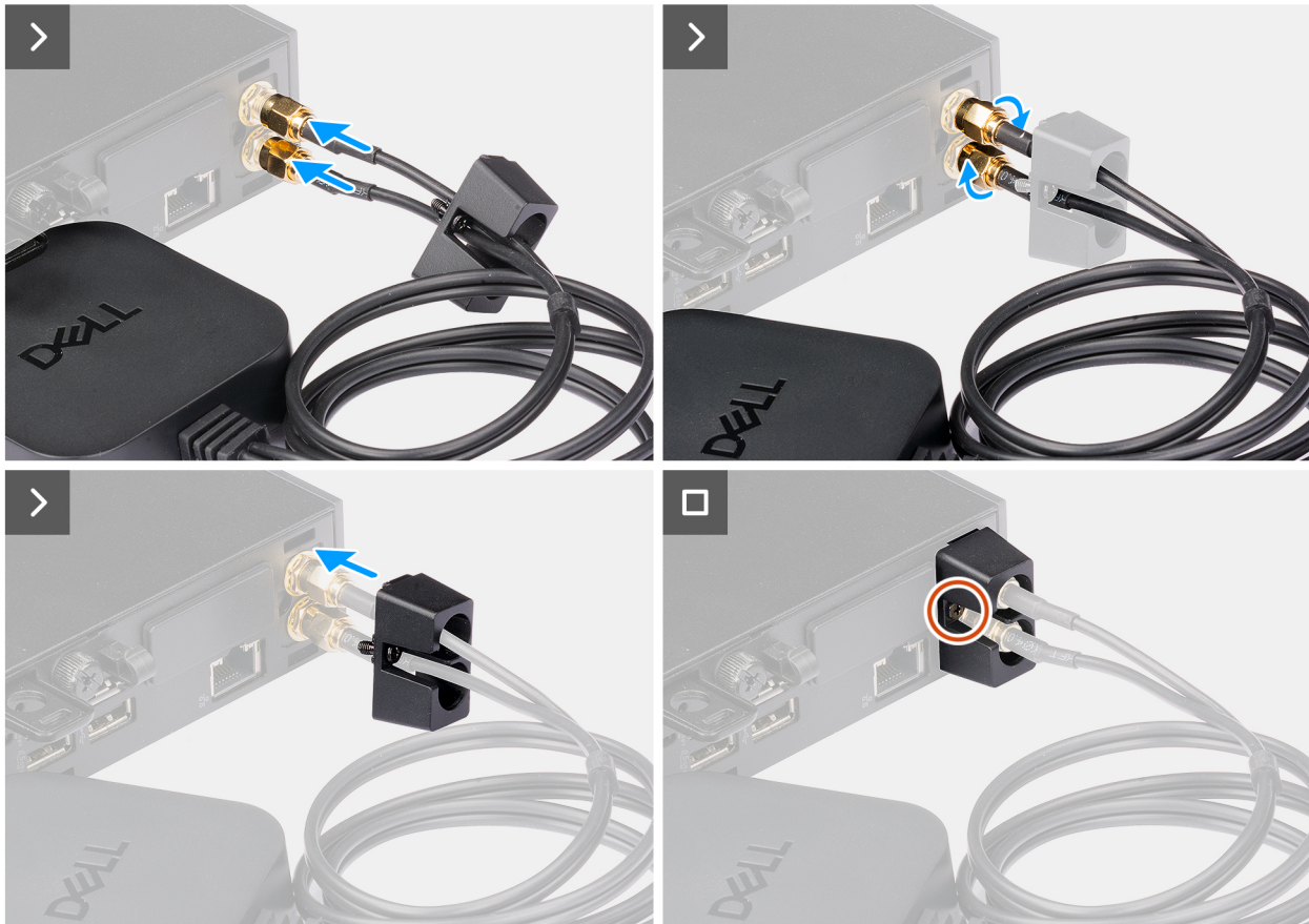
Abbildung 35. Einbauen der externen Puck-Antenne
