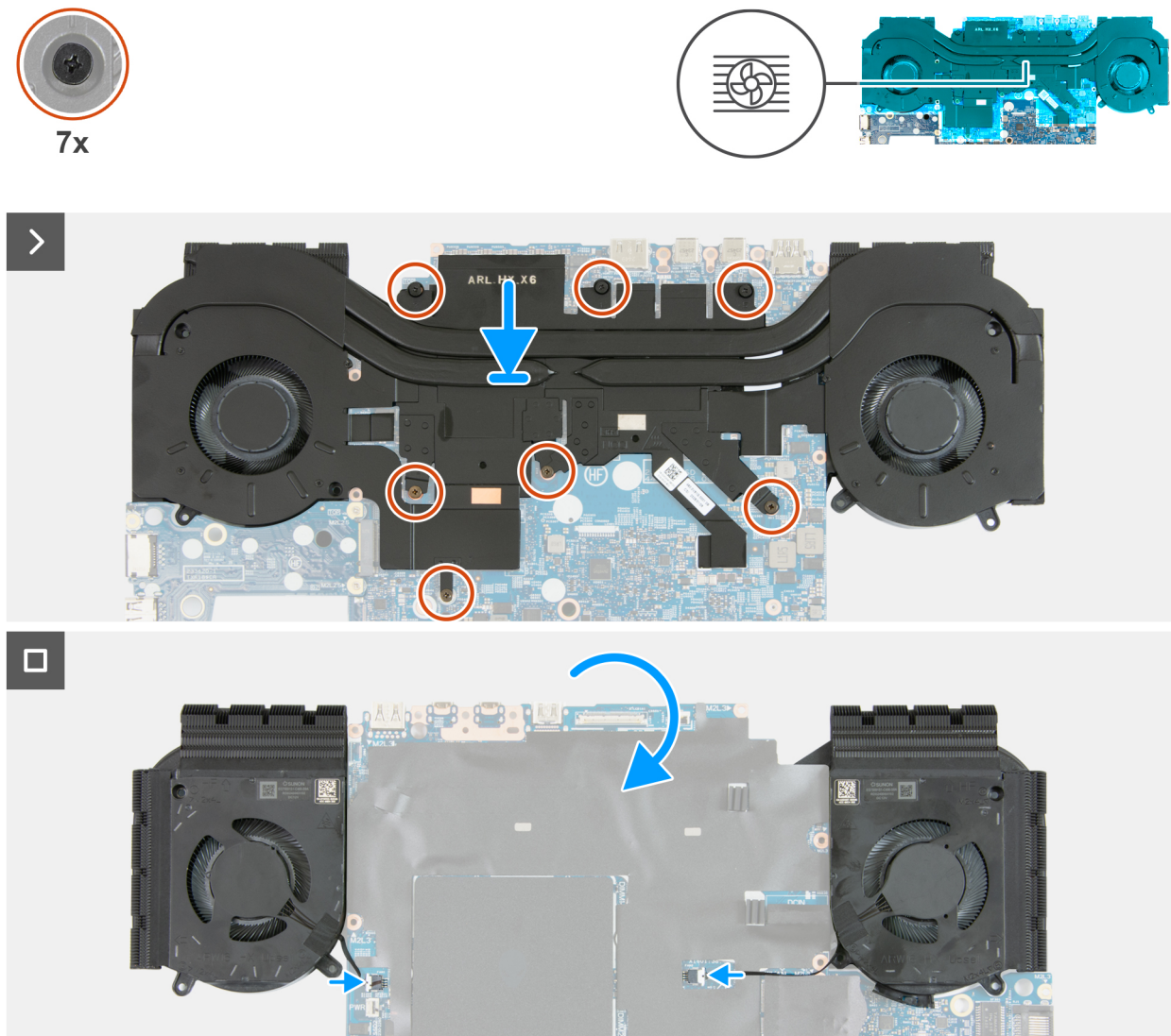
Abbildung 62. Installieren der Lüfter- und Kühlkörperbaugruppe
