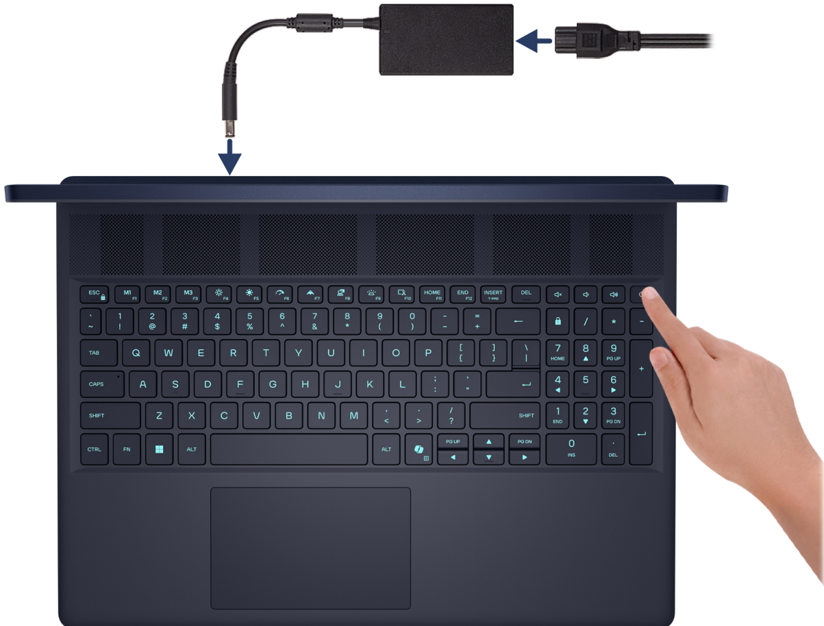
Abbildung 8. Anschließen des Netzteils und Drücken des Netzschalters
