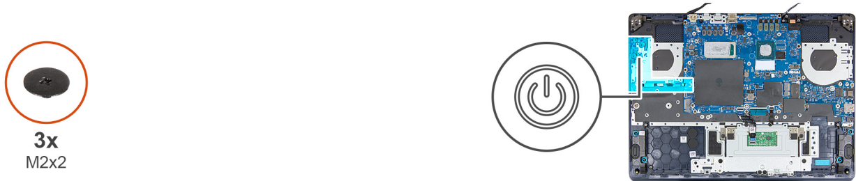
Abbildung 59. Einbauen des Netzschalters und der Netzschalterplatine
