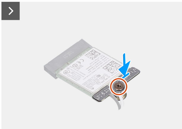
Abbildung 35. Installieren der Wireless-Karte
