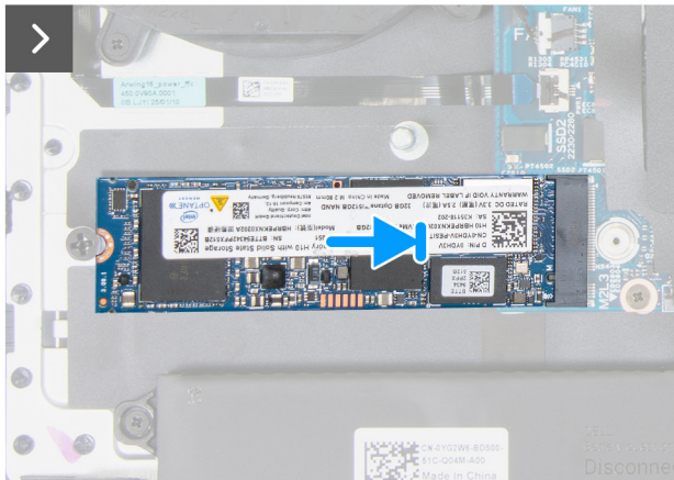
Abbildung 31. Installieren des M.2 2280-SSD-Laufwerks im Steckplatz SSD2
