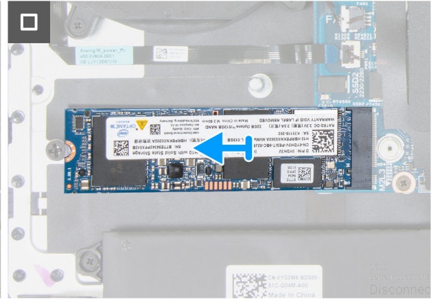
Abbildung 30. Entfernen des M.2 2280-SSD-Laufwerks aus dem Steckplatz SSD2
