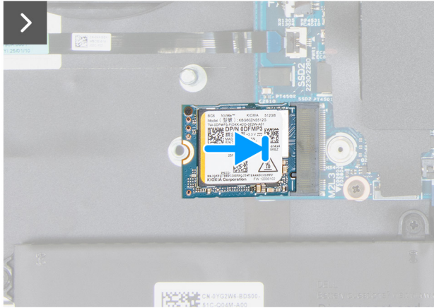
Abbildung 26. Entfernen des M.2 2230-SSD-Laufwerks aus dem Steckplatz SSD2
