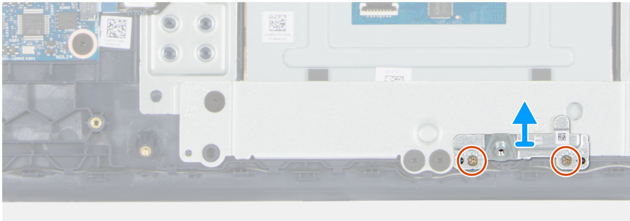
Abbildung 42. Entfernen der Akkuhalterung
