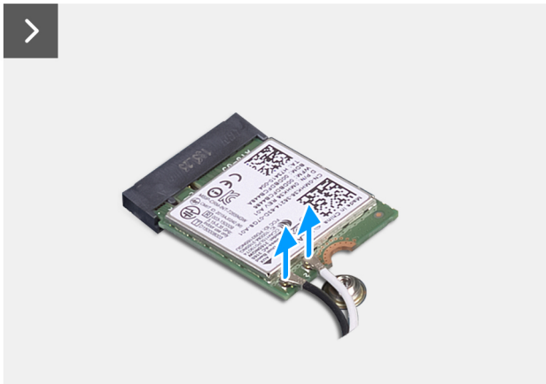
Abbildung 34. Entfernen der Wireless-Karte
