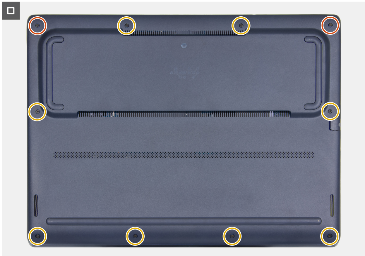
Abbildung 17. Anbringen der Bodenabdeckung
