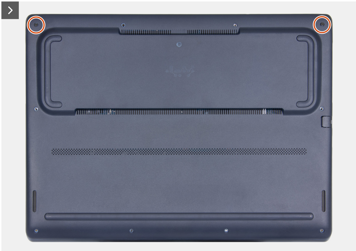
Abbildung 11. Lösen der unverlierbaren Schrauben an der Bodenabdeckung
