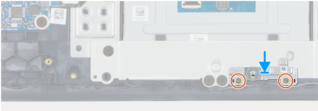
Abbildung 43. Installieren der Akkuhalterung
