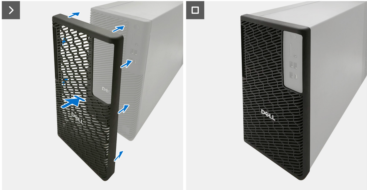
Abbildung 22. Installieren des Staubfilters
