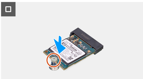
Abbildung 30. Installieren des M.2 2230-Solid-State-Laufwerks in Steckplatz 0
