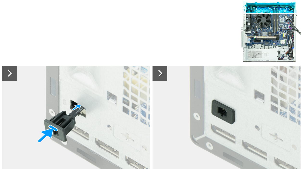
Abbildung 71. Installieren des Kabels des Remote-Netzschalters
