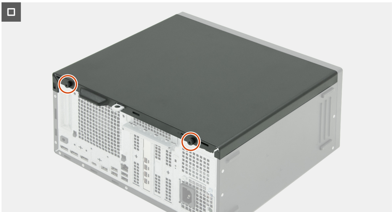
Abbildung 16. Installieren der linken Abdeckung
