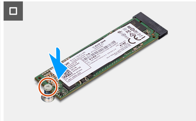
Abbildung 39. Installieren des M.2 2280-Solid-State-Laufwerks in Steckplatz 2
