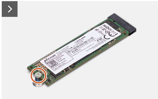
Abbildung 31. Entfernen des M.2 2280-Solid-State-Laufwerks aus Steckplatz 0
