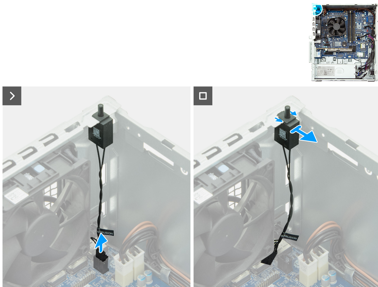
Abbildung 65. Entfernen des Eingriffsschalters
