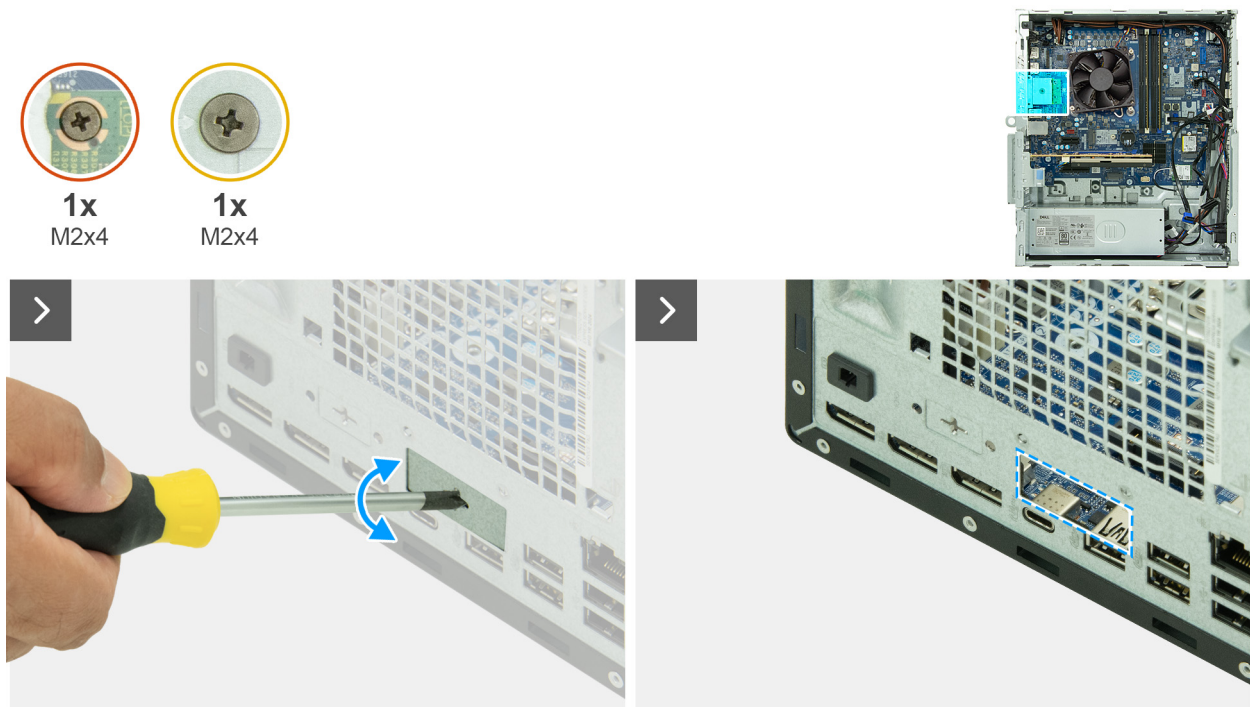
Abbildung 76. Installieren des optionalen Portmoduls
