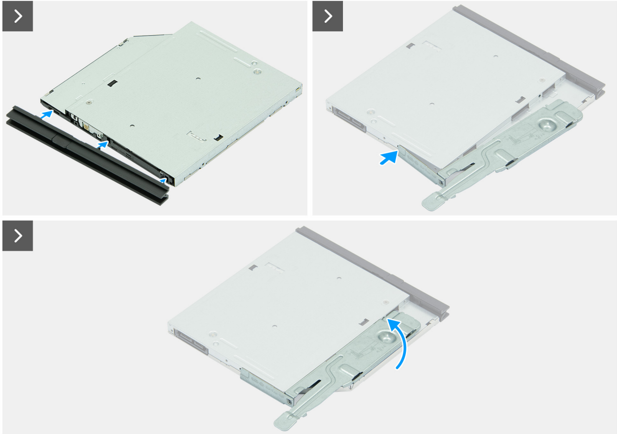
Abbildung 56. Installieren des optischen Laufwerks
