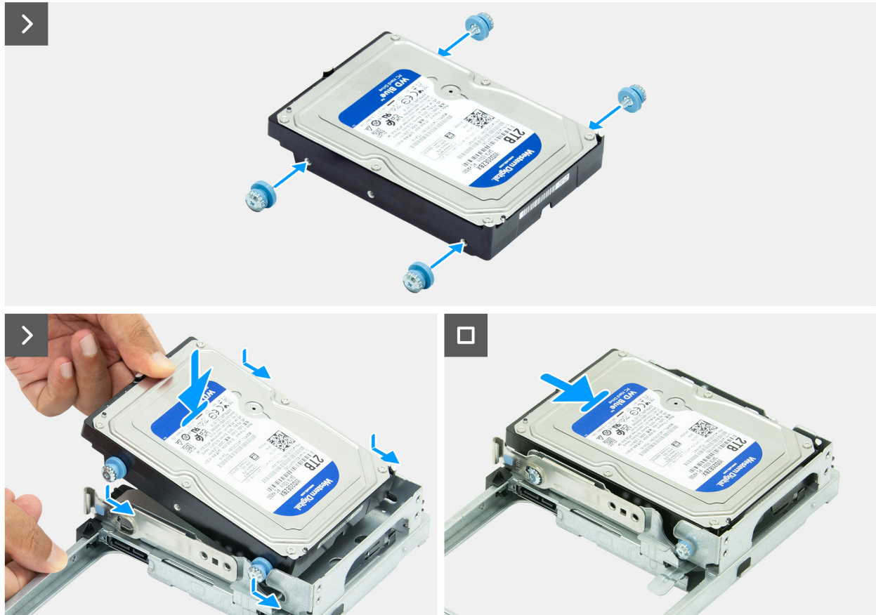
Abbildung 64. Einsetzen des Festplattenlaufwerks
